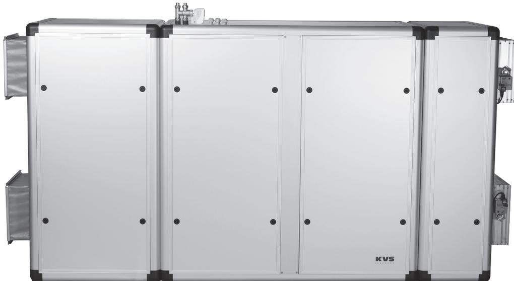
Der Gehäuserahmen dieser Entfeuchtungsgeräte ist aus eloxierten Aluminiumprofilen hergestellt. Auch die in zweischaliger Bauweise gefertigten Verkleidungsteile bestehen aus eloxiertem Aluminium und verfügen über eine innen liegende Isolierung sowie eine umlaufende Dichtung.
